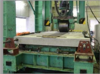
図-移動輪走行試験機
