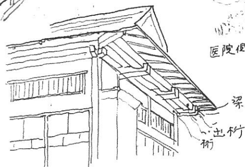
桁上に活アゴで向あきに 梁を架け、出桁で抑える 木の組手の様子
